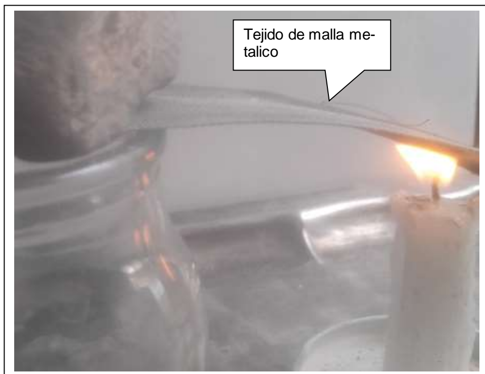
Fig 1.2.2 Comportamiento Llama con espátula metálica
