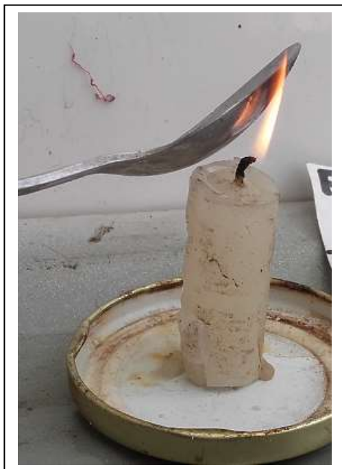
Fig 1.2.2 Comportamiento Llama con espátula metálica
