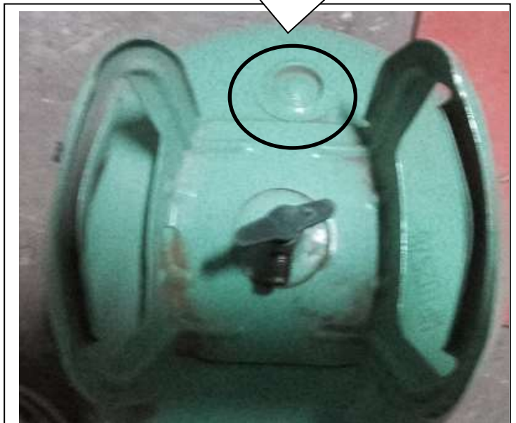
Fig Recipiente Gas Licuado: Freon 12 (C Cl 2 F 2 ) (Compuestos CFC Cloro Fluor Carbonados alto riesgo para el ambiente)
