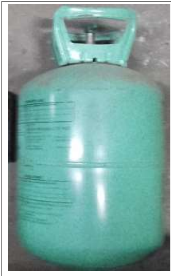
Fig Recipiente Gas Licuado: Freon 12 (C Cl 2 F 2 ) (Compuestos CFC Cloro Fluor Carbonados alto riesgo para el ambiente)
