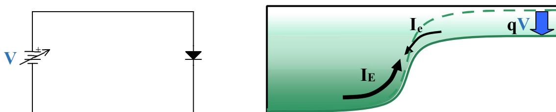
Figura 9: El diodo con polarización directa (ilustrado para los electrones)
