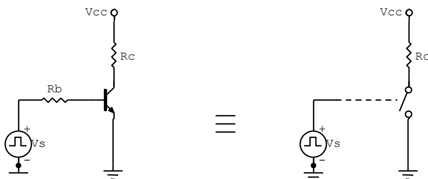
Figura 31: El transistor en conmutación trabaja como una llave que abre y cierra
