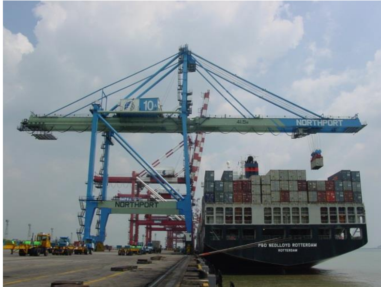
Figura 1: Grúa Portacontenedores Portuaria de Muelle tipo Pórtico (Vista Lateral)
