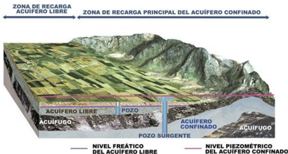
Figura 3.1. Tipos de acuíferos y su comportamiento. (Extraído del Instituto Geológico y Minero de España).
