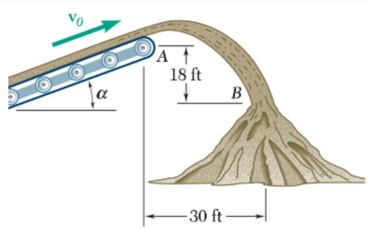
Determinar la velocidad  $v_0$  de la banda.
