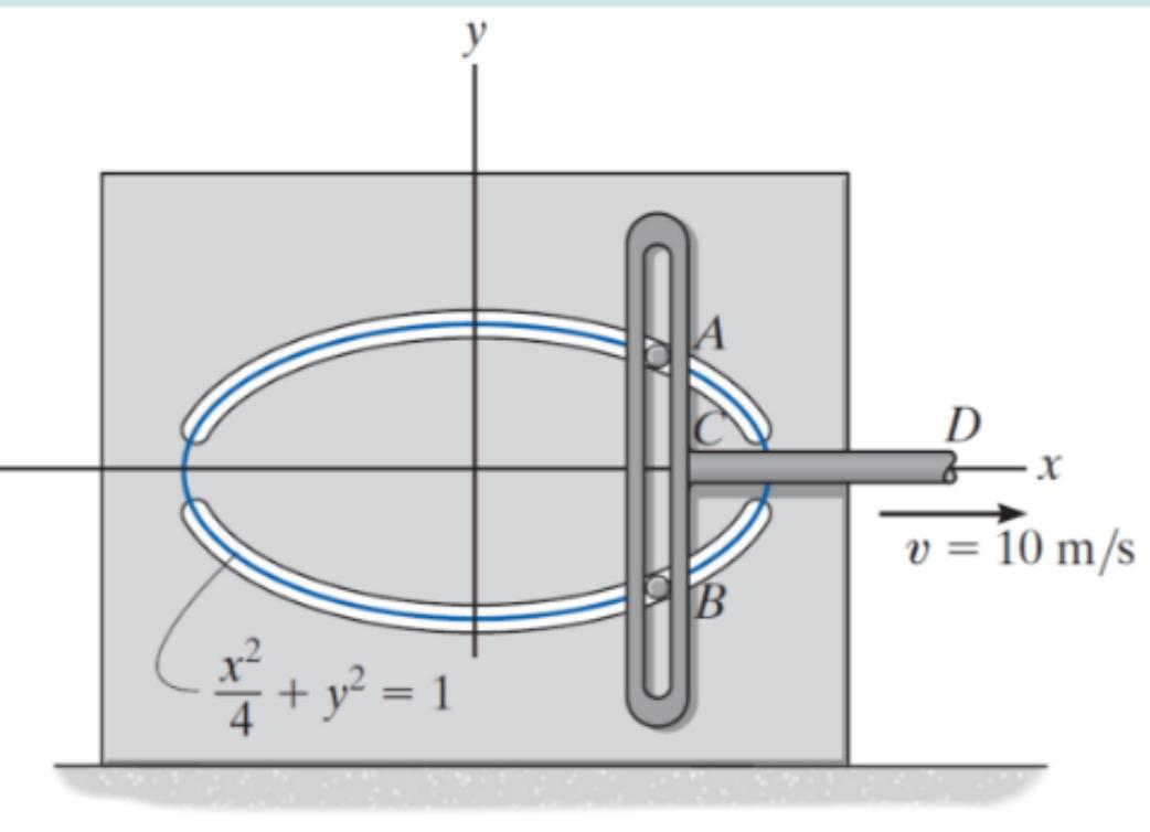
Determinar la magnitud de la **velocidad** de la **espiga A** cuando  $x = 1 \text{ m}$
