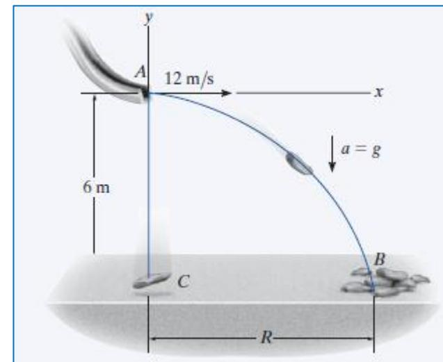
**Movimiento horizontal.** Con  $t_{AB}$  calculado, R se determina como sigue:
