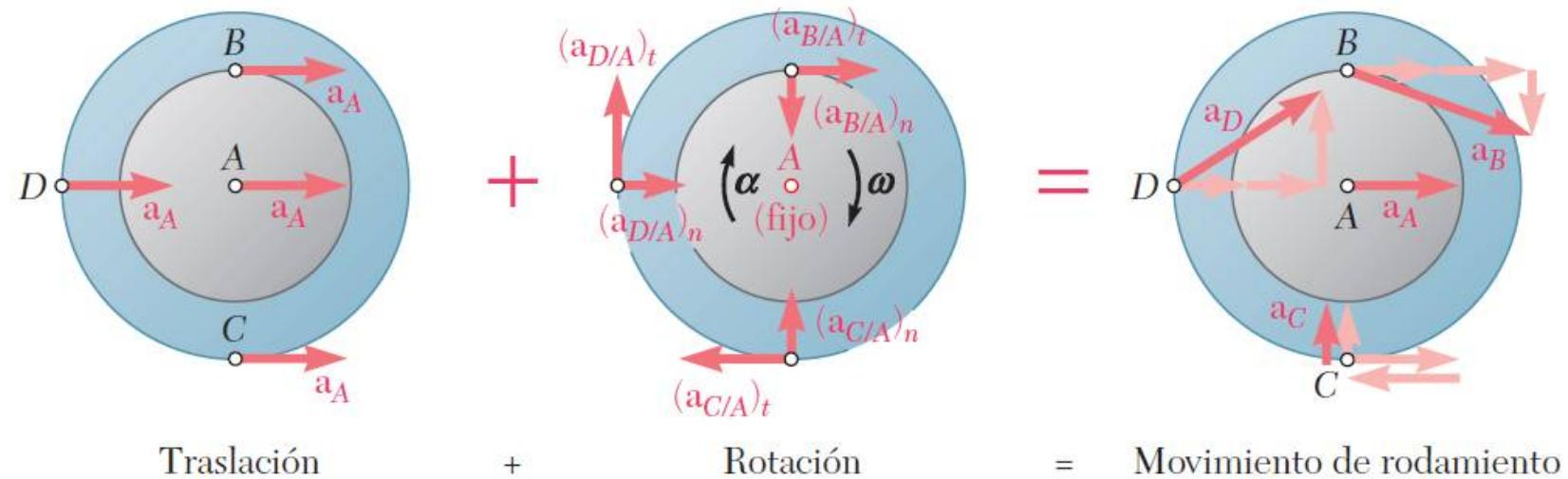
a) **Aceleración angular del engrane.** En el problema resuelto 15.2,  $x_A = -r_1\theta$  y  $v_A = -r_1\omega$ . Diferenciando la última ecuación con respecto al tiempo, se obtiene  $a_A = -r_1\alpha$ .
