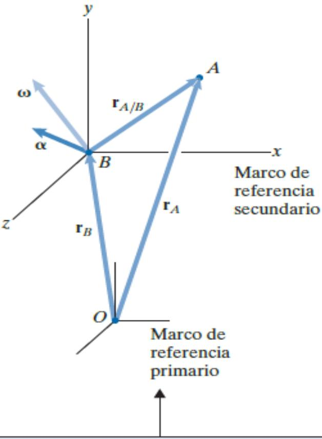
Los términos  $v_A$ ,  $v_B$ ,  $a_A$ , y  $a_B$  son las velocidades y aceleraciones de los puntos A y B relativas al marco de referencia primario.  $\omega$  y  $\alpha$  son la velocidad y la aceleración angulares del marco de referencia secundario relativas al marco de referencia primario. Los términos  $v_{A \text{ rel}}$  y  $a_{A \text{ rel}}$  son la velocidad y la aceleración de A relativa al marco de referencia secundario.
