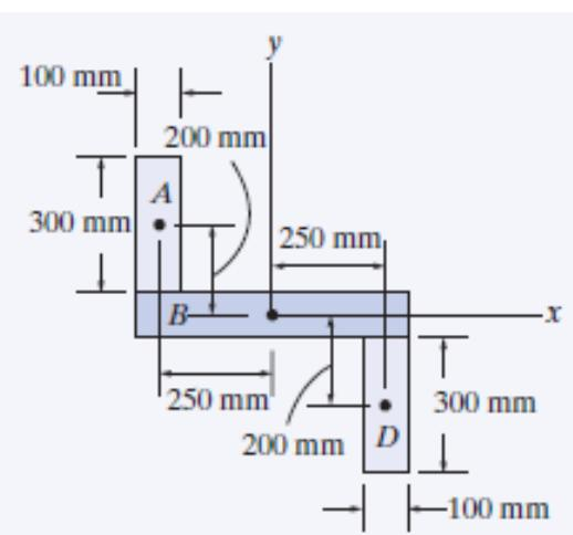
**Partes compuestas.** La sección transversal puede subdividirse en las tres áreas rectangulares  $A$ ,  $B$  y  $D$  que se muestran en la figura inferior. Para efectuar el cálculo, el centroide de cada uno de esos rectángulos está localizado en la figura.
