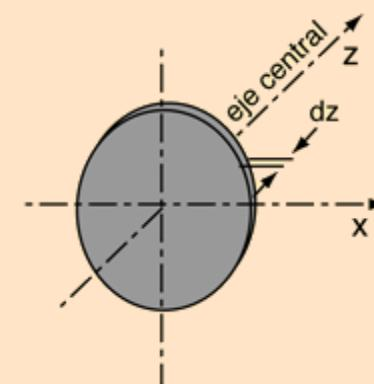
La obtención del momento de inercia de un cilindro completo sobre un diámetro de su extremo, consiste en una suma de infinitos discos delgados, a diferentes distancias de ese eje. Esto nos lleva a una integral desde  $z=0$  hasta  $z=L$ . Para cualquier disco dado a una distancia  $z$  de su eje x, usando el teorema de los ejes paralelos, nos da el momento de inercia sobre el eje x.
