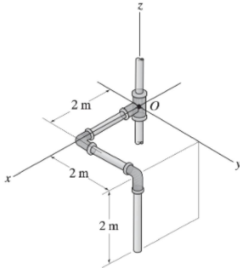
Calcule el momento de inercia de la pieza con respecto al **eje x**.
