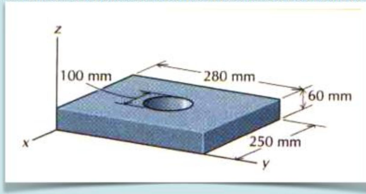
Calcule el producto de inercia  $I_{xy}$  de la pieza.
