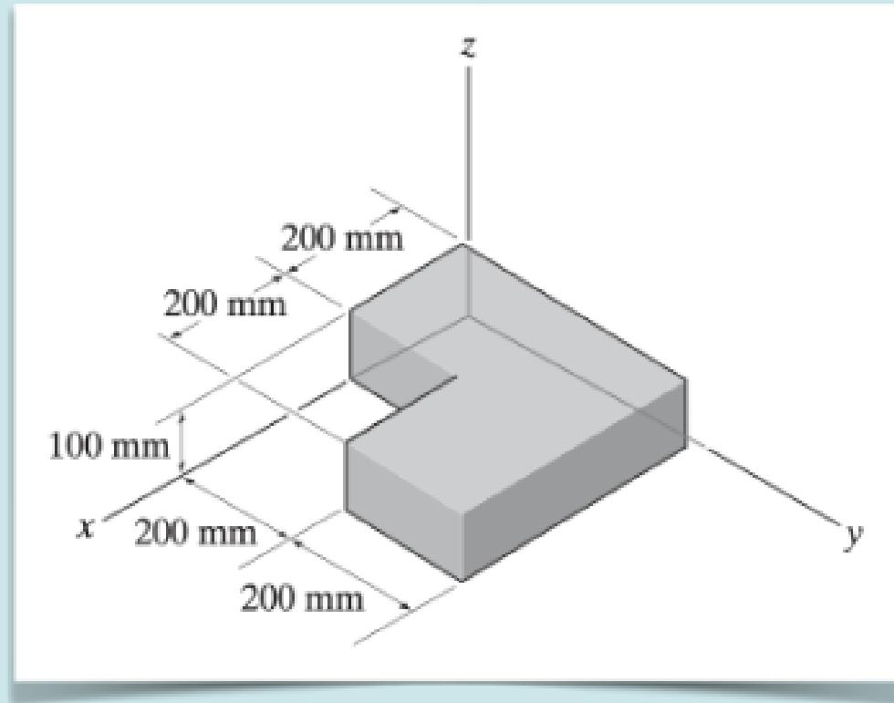
Calcule el producto de inercia  $I_{xy}$  de la pieza.
