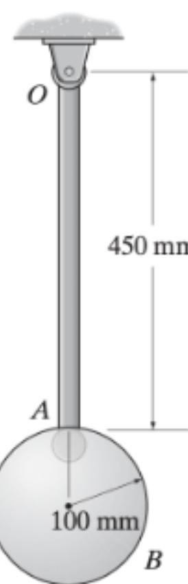
Calcule el momento de inercia total del péndulo respecto al eje perpendicular a la figura que pasa por el punto O.
