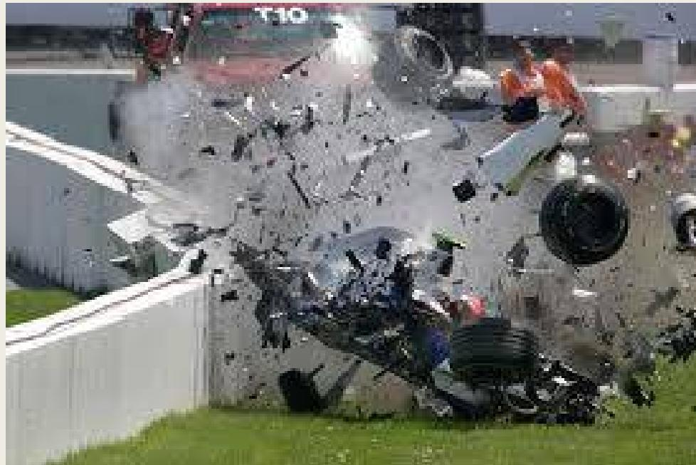
Si un auto golpea la pared la energía cinética se transformará en trabajo, lo cual causará que la pared y el auto se deformen. Conociendo la cantidad de energía absorbida por la pared, es posible diseñar un colchón antichoque.
