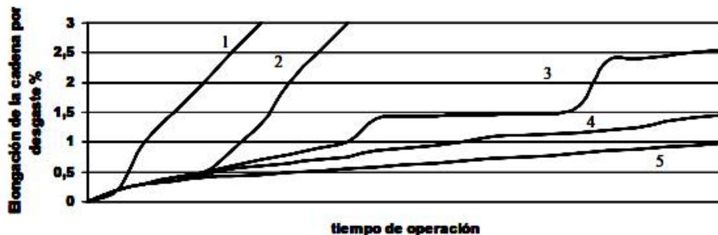
Fig. 21 – Desgaste de la cadena (cuantificado por su elongación) durante su vida útil de explotación en dependencia de las condiciones de lubricación: 1- Sin lubricación [desgaste muy intenso, reporta un mínimo plazo de vida útil] , 2 – Lubricada solo durante el montaje inicial [mantiene un bajo índice de desgaste hasta que desaparece la lubricación], 3 – Lubricación manual y periódica [ocasionalmente queda sin lubricación y aumenta en esos periodos la intensidad del desgaste], 4- Lubricación continua pero sin cuidado de mantener la limpieza en el aceite, 5 – Lubricación continua adecuada [garantiza la mayor vida útil de la cadena].
