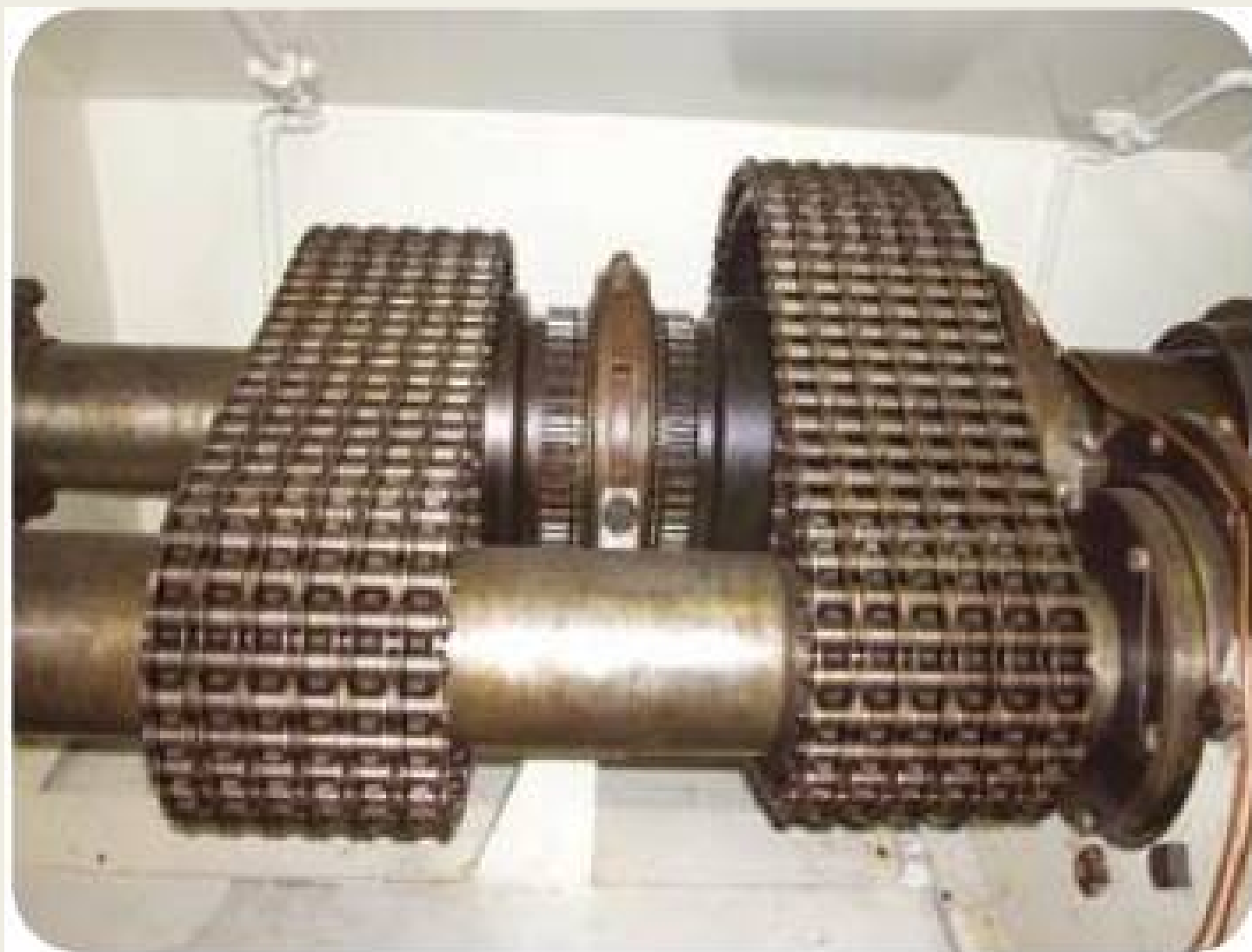
Cadena petrolera de hileras múltiples en una bomba de lodo
