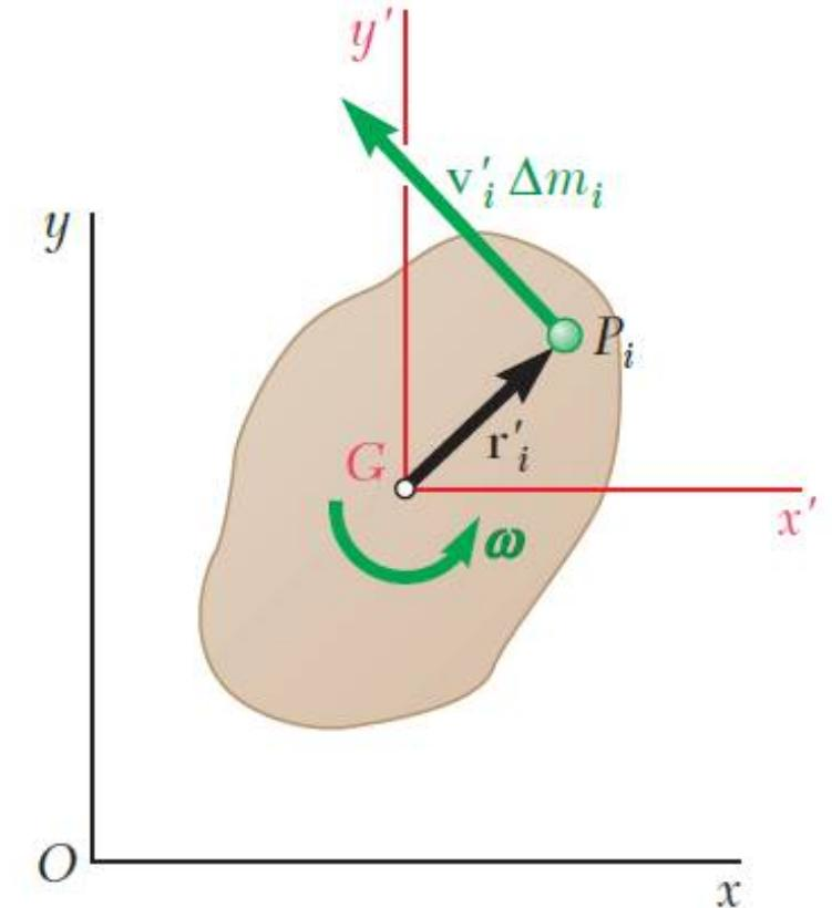
**La variación de la cantidad de movimiento angular de la placa se representa mediante un vector de la misma dirección que  $\boldsymbol{\alpha}$  (perpendicular a la placa) y de magnitud  $\bar{I} \boldsymbol{\alpha}$**
