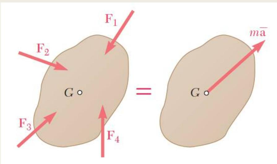
En un cuerpo en translación, la aceleración angular es igual a cero y las fuerzas efectivas se reducen al vector  $m\bar{a}$  fijo en G. Por lo cual la resultante de las fuerzas externas que actúan sobre un cuerpo rígido en translación pasa por el centro de masa
