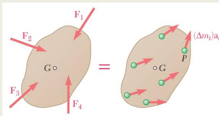
Se puede sustituir las fuerzas efectivas por un vector  $m\bar{a}$  fijo en el centro de masa G de la placa y por un par de momento  $\bar{I}\alpha$ .
