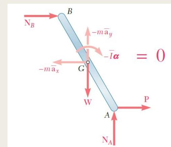
En la mayor parte de las aplicaciones de ingeniería se trabaja con cuerpos rígidos que se mueven bajo restricciones determinadas. En tales casos existen relaciones entre las componentes de la aceleración del centro de masa G del cuerpo considerado y su aceleración angular. Se dice que el movimiento correspondiente es un movimiento restringido. Para resolverlo es necesario un análisis cinemático preliminar del problema en cuestión.
