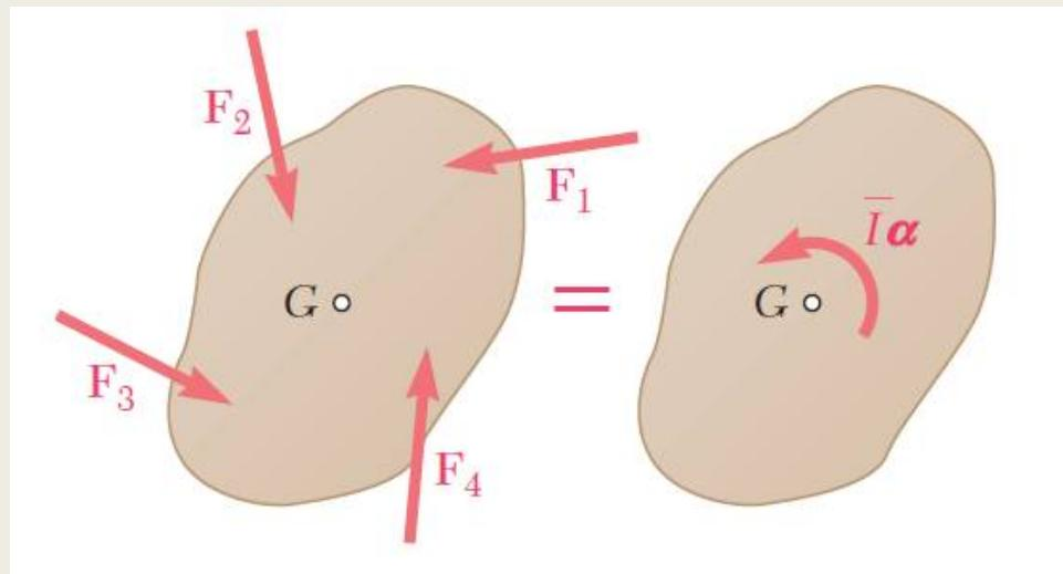
Cuando una placa o un cuerpo simétrico con respecto al plano de referencia gira alrededor de un eje fijo y pasa por su centro de masa G, el cuerpo está en rotación centroidal. La aceleración  $a$  es igual a cero. Las fuerzas efectivas se reducen al par  $\bar{I}\alpha$ . Las fuerzas externas que actúan sobre el cuerpo son equivalentes a un momento  $\bar{I}\alpha$ .
