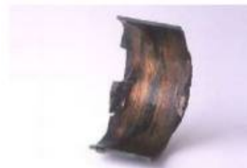
Cojinete desgastado por falta de lubricación. 10
