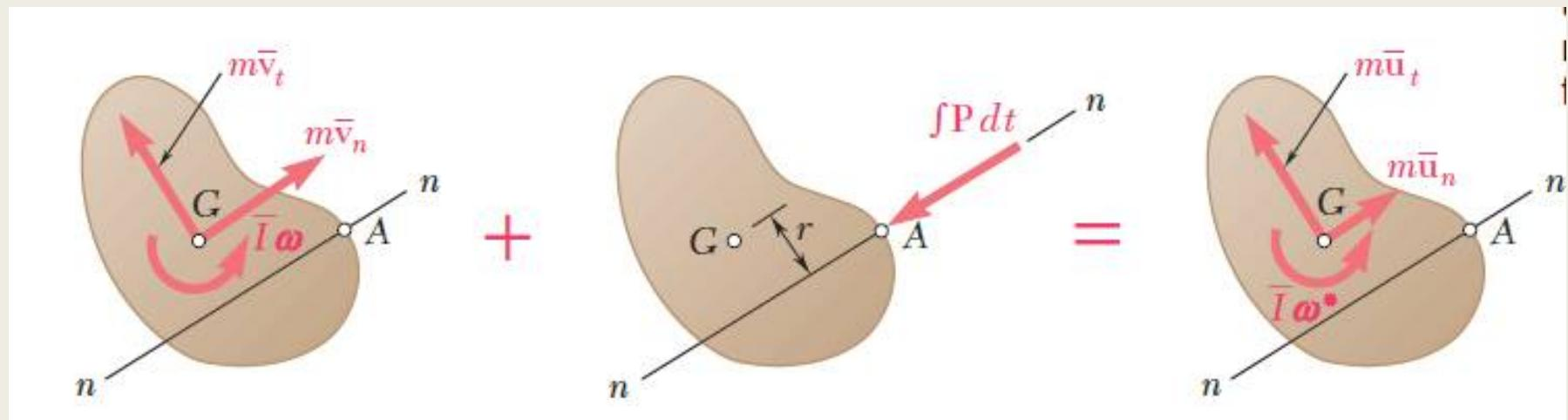
$\bar{v}$  y  $\bar{u}$       Velocidad del centro de masa al principio y al final del período de deformación
