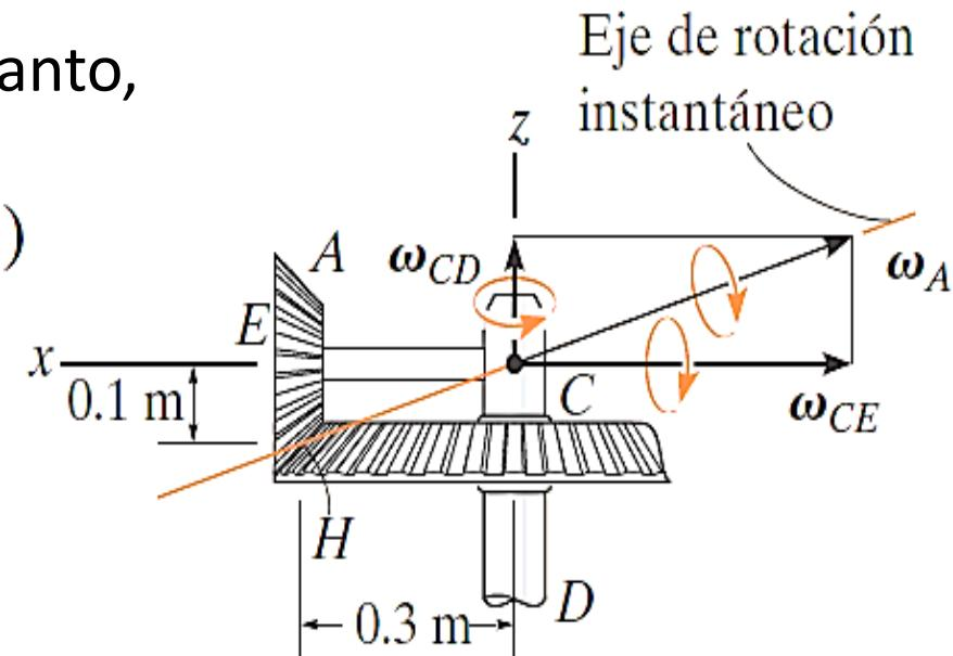
Los ejes  $x$ ,  $y$ ,  $z$  en la figura representan *ejes de inercia principales* en  $C$  para el engrane. Como el punto  $C$  es un punto de rotación fijo, puede aplicarse la ecuación para determinar la energía cinética, es decir,
