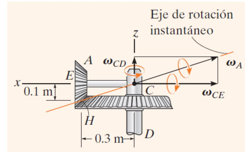
**Energía cinética.** Como inicialmente el engrane está en reposo, su energía cinética inicial es cero. En la figura se muestra un diagrama cinemático del engrane.
