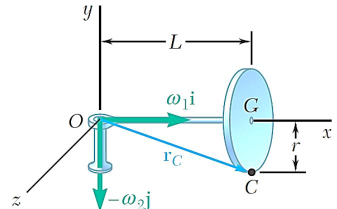
**c) Energía cinética.** Al utilizar los valores que se obtuvieron para los momentos de inercia y las componentes de  $\omega$ , se tiene
