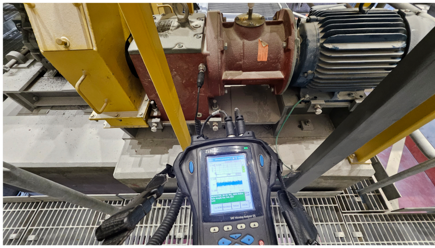
Medición sobre motorreductor
