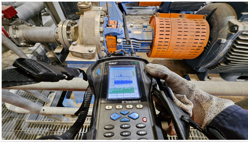
Medición sobre bomba centrífuga
