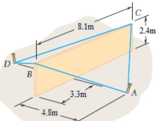
Un muro de hormigón prefabricado se sostiene temporalmente por los cables mostrados en la figura. Se sabe que la fuerza en el cable **AB** es de 3.7kN y en el cable **AC** es de 5.3kN. Determine la magnitud y la dirección de la resultante de las fuerzas ejercidas por los cables **AB** y **AC** sobre la estaca A.
