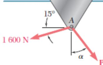
Un carrito que se mueve a lo largo de una viga horizontal está sometido a dos fuerzas, como se muestra en la figura. a) Si se sabe que  $\alpha = 25^\circ$ , determine por trigonometría la magnitud de la fuerza P tal que la fuerza resultante ejercida sobre el carrito sea vertical. b) ¿Cuál es la magnitud correspondiente de la resultante?
