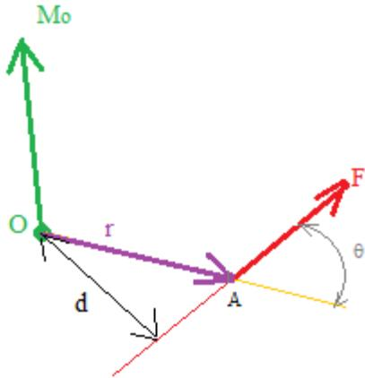
La fuerza **F** actúa en un punto A de un cuerpo rígido, la posición de A se define con el vector **r** que une el punto de referencia **O** con A. Ambos vectores **F** y **r** definen un plano.
