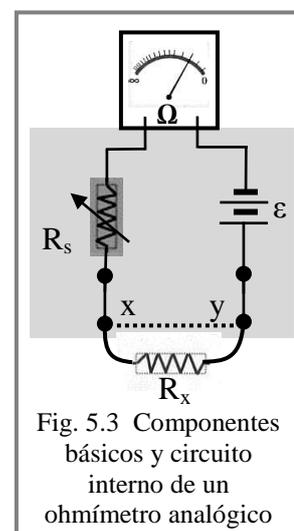
En los multímetros analógicos el uso como ohmímetro se consigue usando el mismo galvanómetro de aguja complementando el instrumento con circuitos y elementos auxiliares como los descritos, inclusive incorporando otras resistencias en serie posibilitando así mejores condiciones de medición con aplicación de factores de lectura. Observar que la escala comprende “ $\infty - 0$ ” y que el ajuste con  $R_s$  mencionado, es una operación ineludible.
