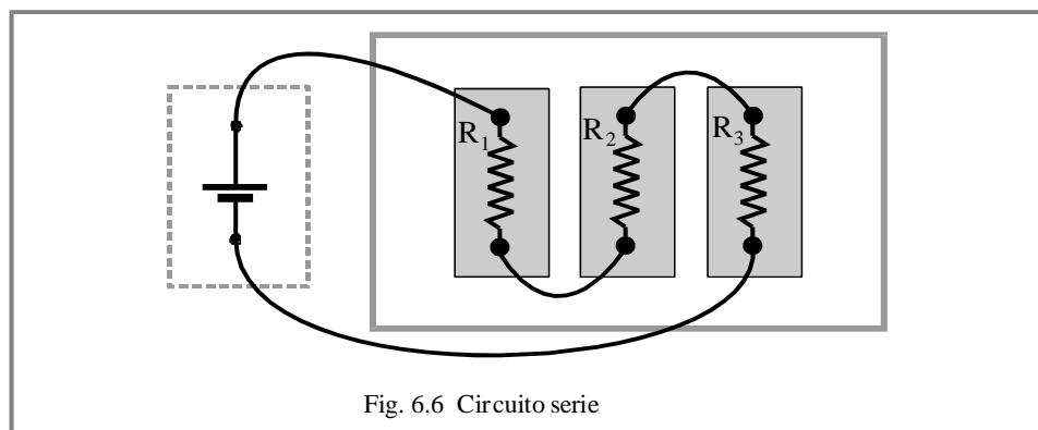
Interconectar los tres resistores del panel conforme a lo representado en el diagrama circuitual.
