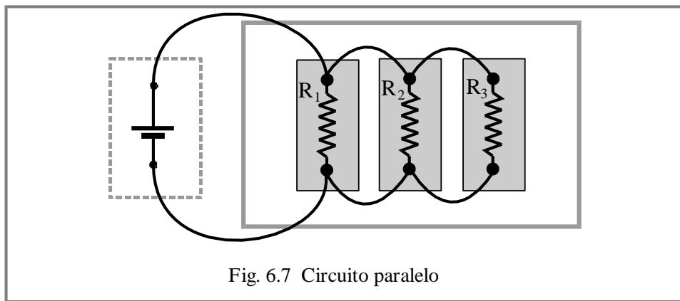
Interconectar los tres resistores del panel conforme a lo representado en el diagrama.
