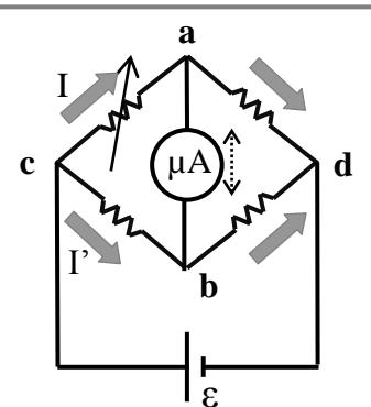
Fig. 6.3 Esquema de distribución de corrientes.
