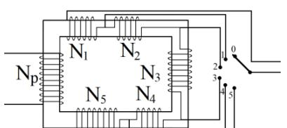
Si se lo conecta a una fuente  $\sim$  de 220 V y se desea obtener 2,0 V; 5,0 V; 10 V; 13; y 20 V, ¿cuántas vueltas  $N_i$  debe tener cada uno de los bobinados?
