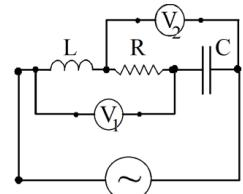
10.10- Un circuito L-R-C en serie está conectado a una fuente de ca de 120 Hz que tiene  $V_{\text{rms}} = 80,0 \text{ V}$ . El circuito tiene una impedancia de  $105 \Omega$  y una resistencia de  $75,0 \Omega$  a esta frecuencia. ¿Cuál es la potencia media que la fuente entrega al circuito?
