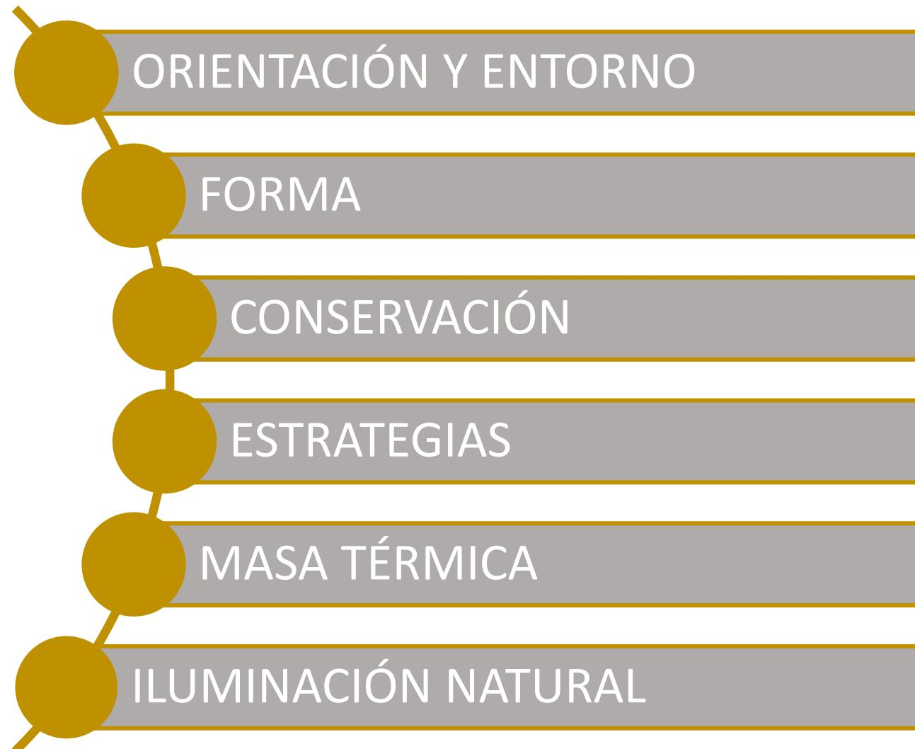
**El diseño bioclimático aprovecha los recursos climáticos de un lugar particular para la climatización natural de un edificio**
