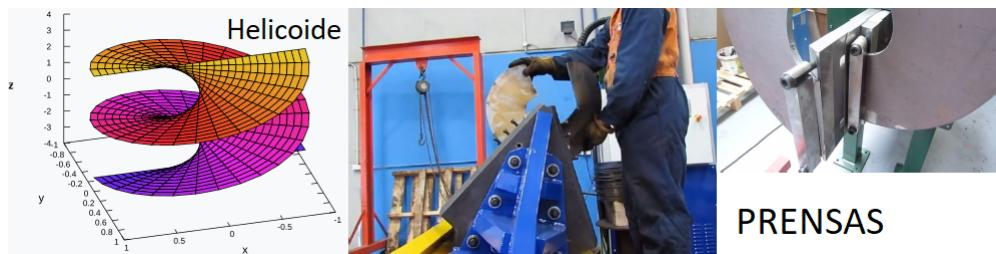
Para construir este tipo de piezas, puede por ejemplo, utilizarse prensas o unirse porciones de material. En las imágenes de la derecha, se corta una corona circular y se la **dobra**, usando una prensa, para obtener la forma deseada. Acá entran en juego características del material, que permite hacer esto sin romperse o deformarse de maneras no deseadas.<sup>1</sup>
