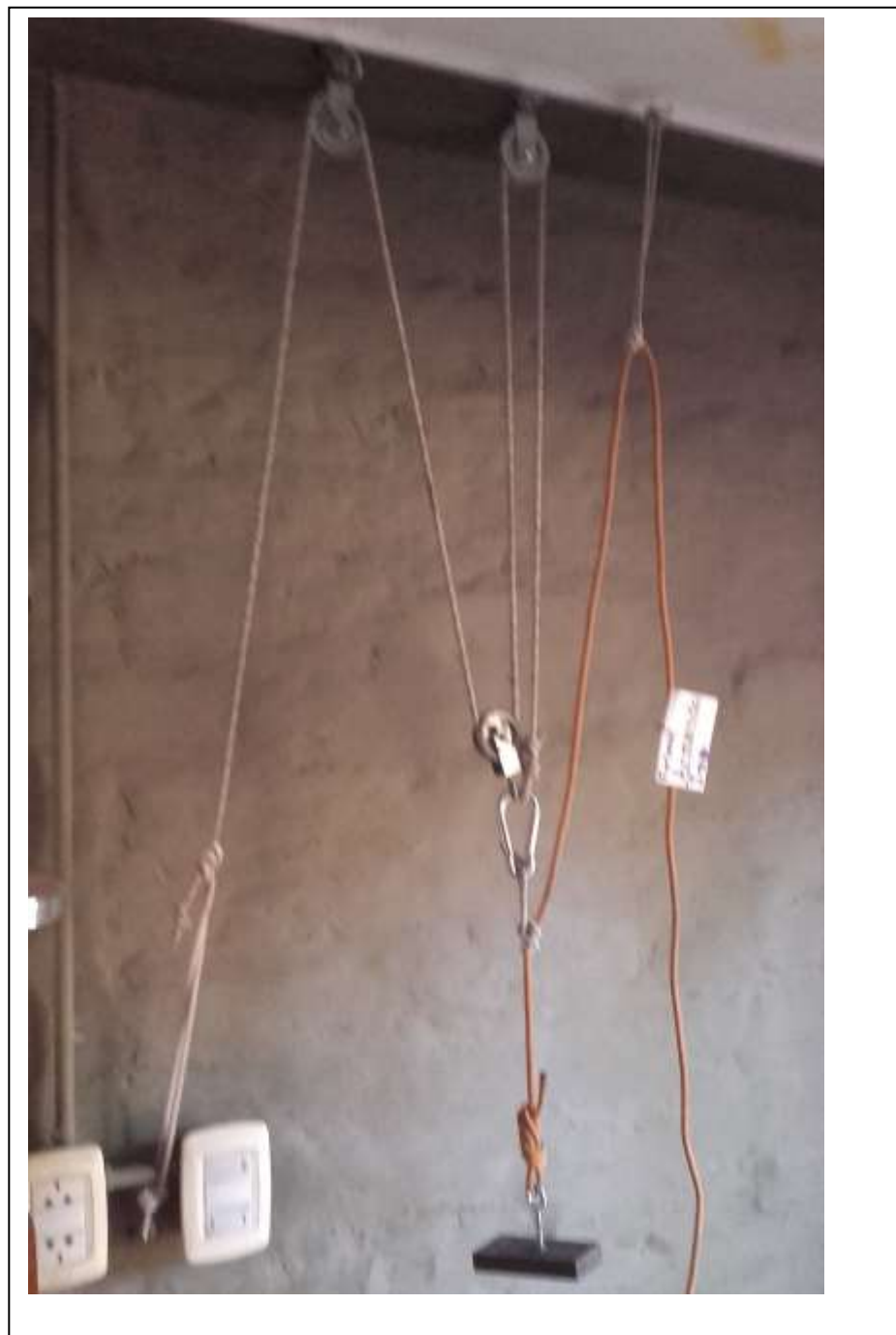
Fig 6.2.3 TA- Rescate Ascenso: Aparejo Rescate 3/1: conexión indirecta al rescatado (fase 1)
