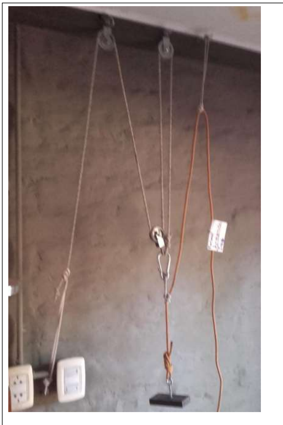
Fig 1.6.3.2.2 TA- Rescate Ascenso: Aparejo Rescate (ejem:3/1): conexión indirecta al rescatado (fase 2)
