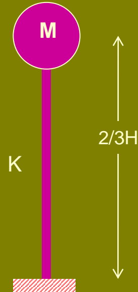
Modelo Dinámico Equivalente. 1 grado de libertad (1 DOF)
