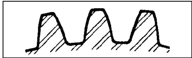
Paso diametral 4 - Paso Circular .7854"
