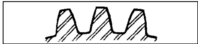
Paso diametral 5 - Paso Circular .6283"
