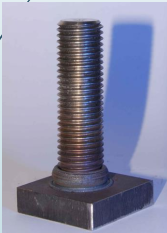
Soldadura por fricción
