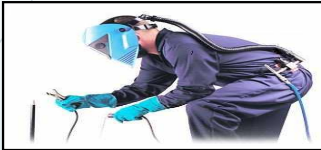
Extracción incorporada a la pistola de soldadura
