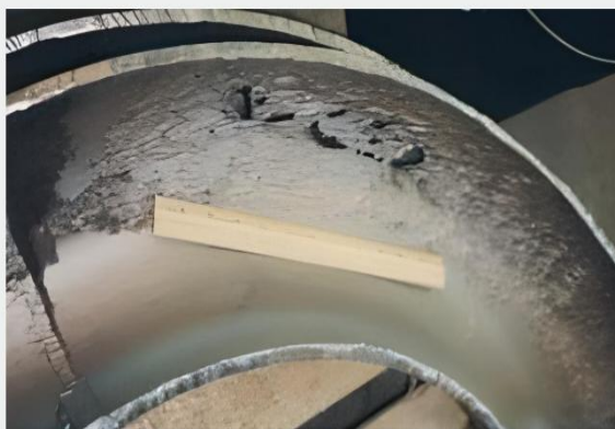
Figura 1 - tubería damnificada por corrosión nafténica
