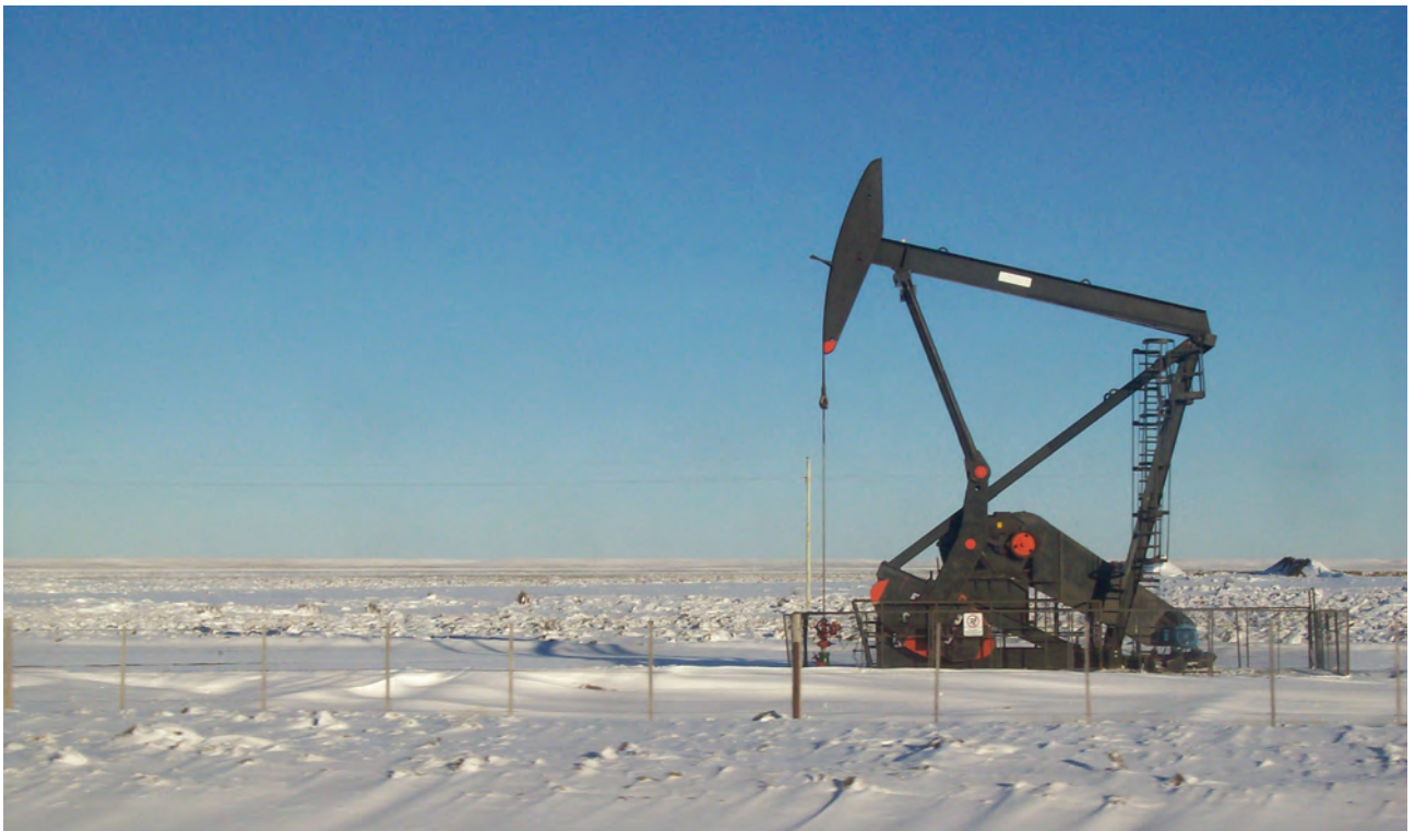
Figura 10. Bombeo mecánico alternativo-cigüeña.
