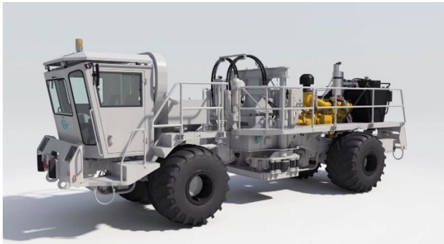
Figura N° 4: vibroseis de la industria SERCEL modelo NOMAD 65 NEO. Fuente de imagen: www.directindustry.fr/prod/sercel-inc (2018)
