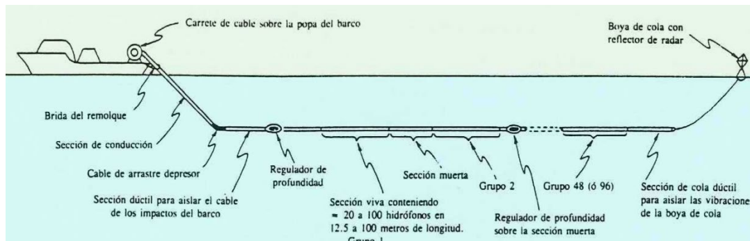
Figura N° 14: esquema del streamer en el agua. Fuente de la imagen: Chelotti, L et al, 2018.
