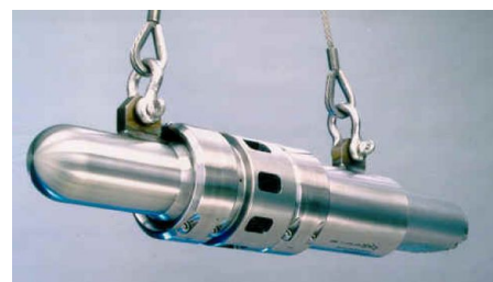
Figura N° 11: Cañones de aire, a la izquierda esquema. Fuente de la imagen: Chelotti, L et al , 2018. Arriba fotografía del cañón de aire. Fuente de la imagen: https://guardianlv.com/tag/seismic-air-guns (2018)
