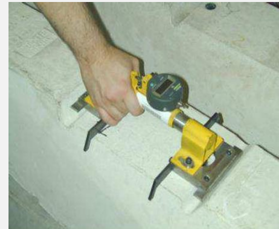
Medida del cajeado de la sujeción
