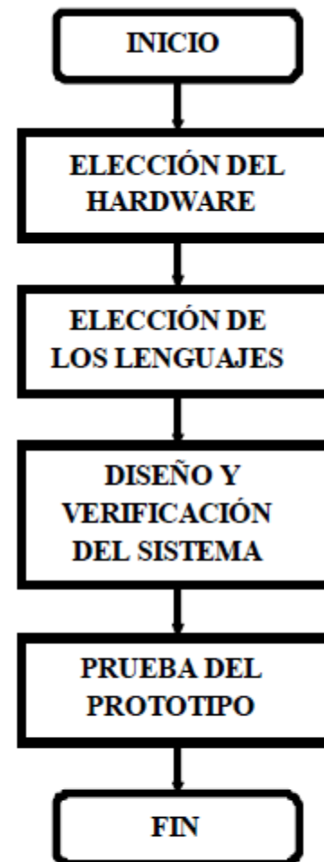
Figura 5.1. Etapas del proyecto de un sistema electrónico de control basado en autómatas programables.
