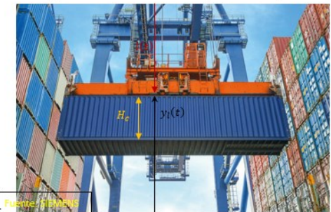
b) Vista frontal, desde el barco, con detalle de headblock/spreader y carga suspendida: container (indicando altura de izaje y_1(t) a base de spreader; y, si hay carga, alto de container H_c a descontar)
