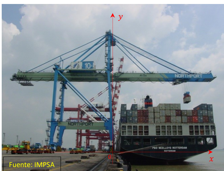
a) Vista lateral ( coordenadas globales x : traslación de carro – y : altura de izaje de la carga ).
