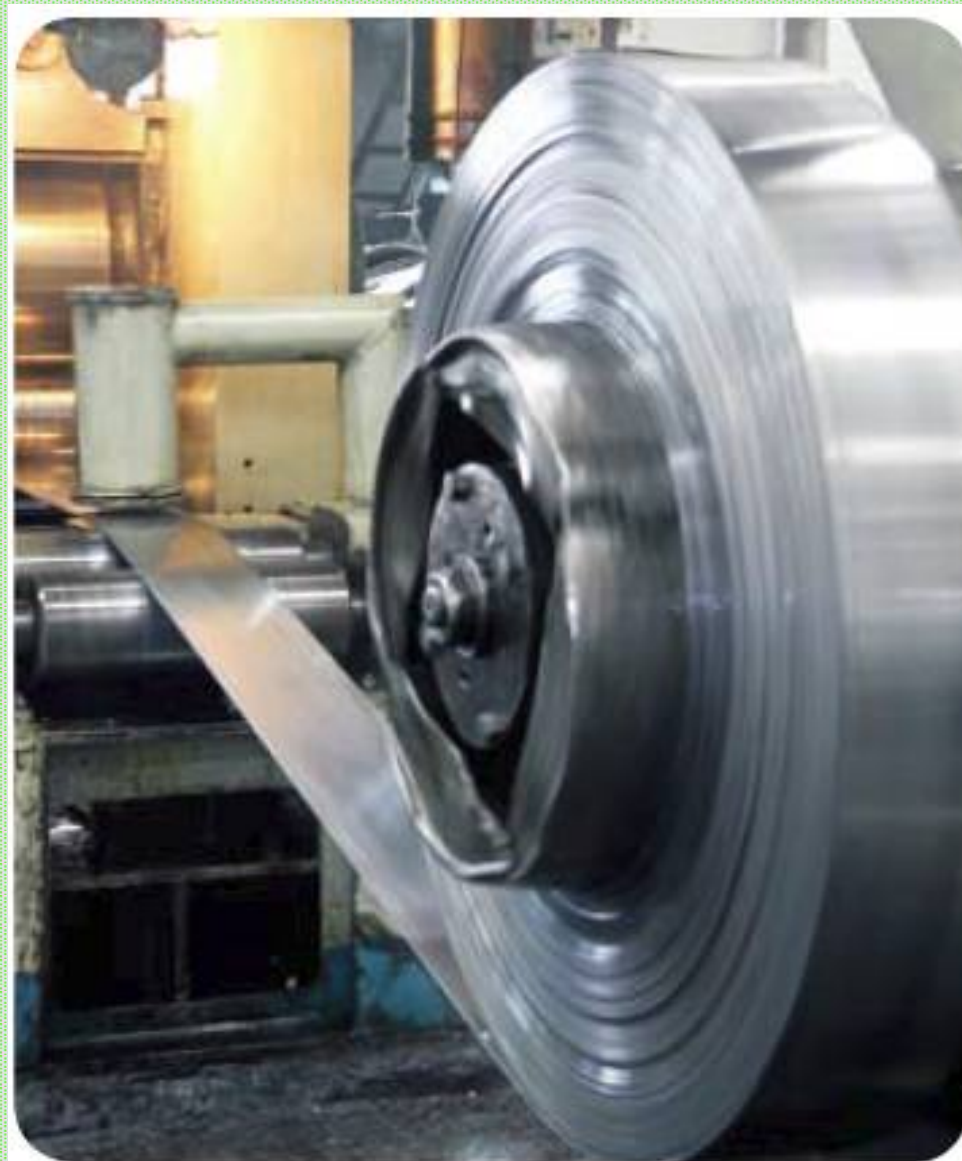
Laminador continuo para obtener espesor uniforme del material de la placa
