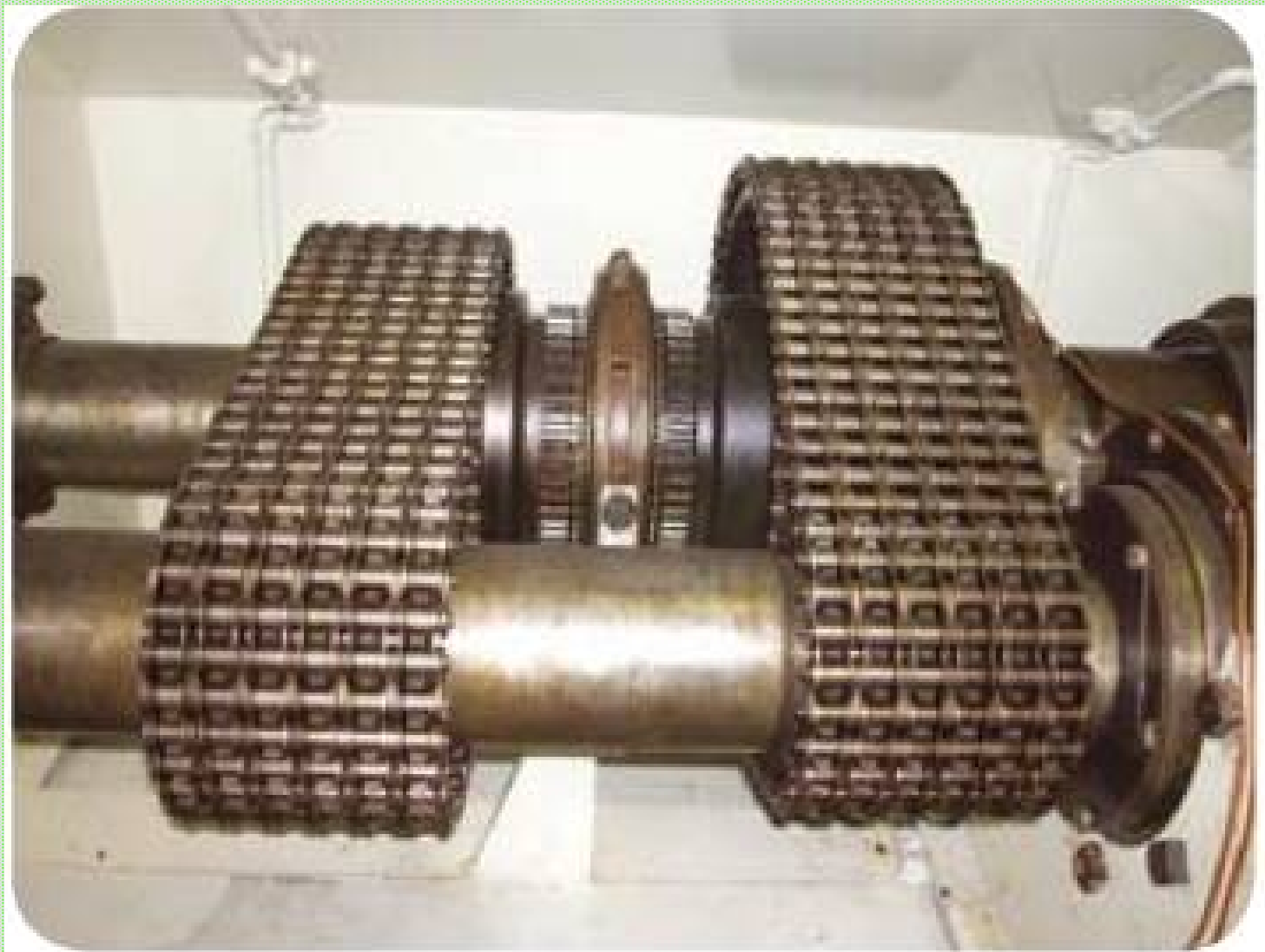
Cadena petrolera de hileras múltiples en una bomba de lodo
