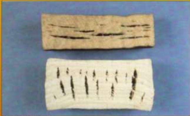
MADERA: DEFECTOS INHERENTES AL MATERIAL GRIETAS INTERNAS POR COLAPSO
