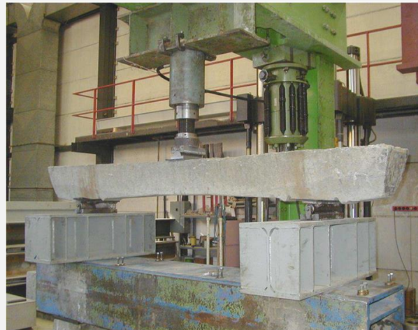
Ensayo de momento negativo en el centro del durmiente
