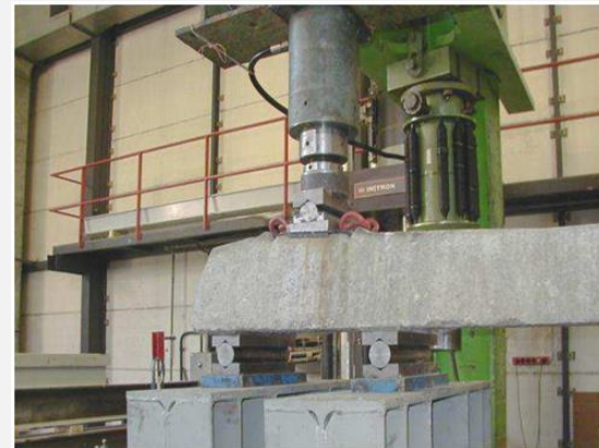
Ensayo de momento positivo en la zona de apoyo del riel
