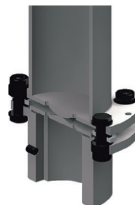
Soporte vertical para evitar una carga axial excesiva de los paquetes de láminas debido al peso del espaciador intermedio
