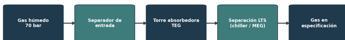
Esquema de la planta de deshidratación (TEG) y ajuste de punto de rocío (LTS)
