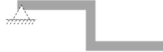
Esquema estructural, bielas concurrentes, cálculo de reacciones (4).
