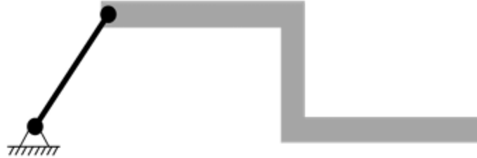
Esquema estructural, biela-V. simple, cálculo de reacciones (1).
