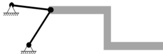
Esquema estructural, bielas concurrentes, cálculo de reacciones (1).
