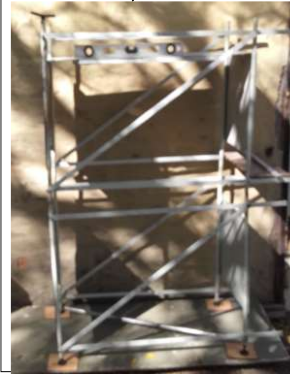
andamio modular mejorado
