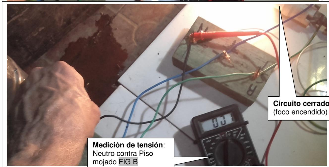
Fig Posible Fuga de energía
