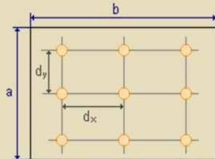
La distancia máxima de separación entre las luminarias dependerá del ángulo de apertura del haz de luz y de la altura de las luminarias sobre el plano de trabajo. Veámoslo mejor con un dibujo:
