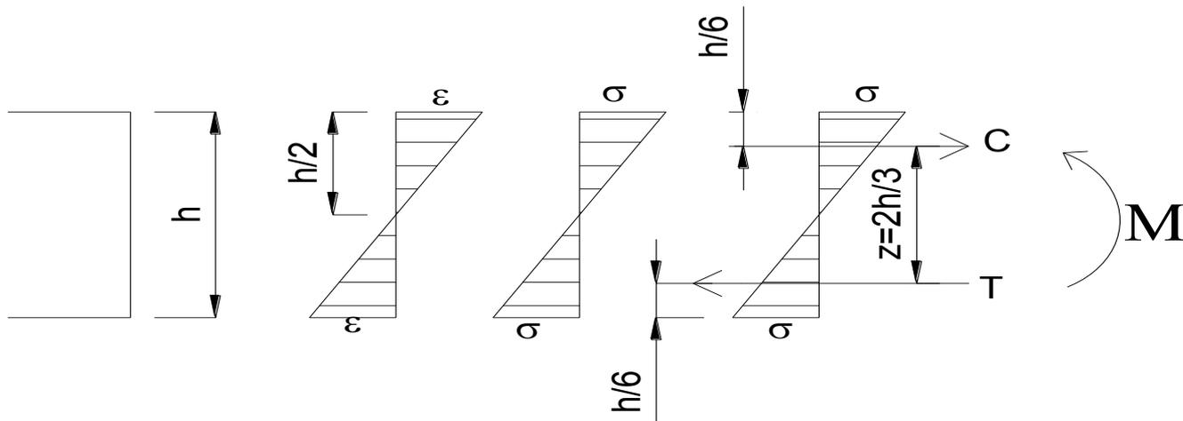
La línea imaginaria por donde se cruzan las tensiones de compresión y de tracción se denomina EJE NEUTRO ya que no posee tensiones y se encuentra en general en el baricentro de la sección.
