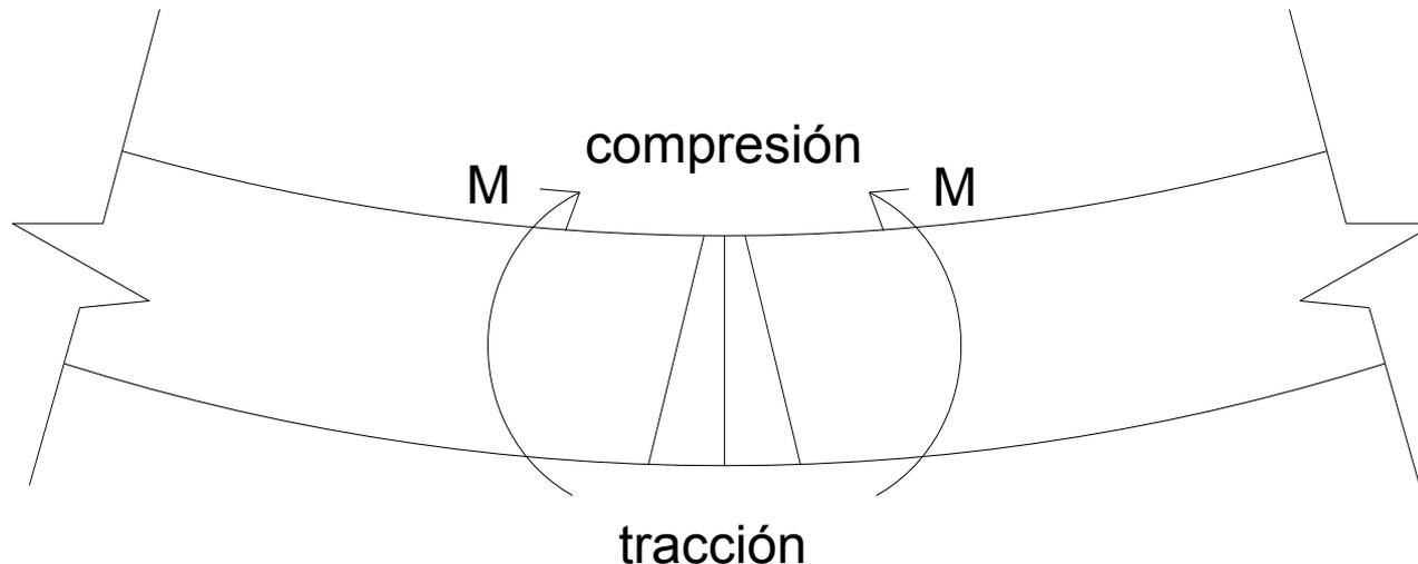
Si bien el perfil de deformaciones en la sección sigue siendo el mismo en un principio, dado que el hormigón es incapaz de soportar tensiones de tracción, la sección comienza a fisurarse en esa zona.
