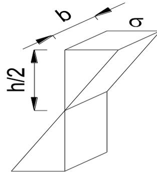
Por sumatoria de momentos en la sección, el momento externo «M» debe ser soportado por las tensiones generadas en la sección (cupla interna).
