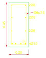
Como se puede ver en el detalle, la viga debe llevar armadura intermedia por armado. Esta armadura colabora en la resistencia a flexión, por lo tanto, se verifica un armado con menos armadura y considerando la armadura central.
