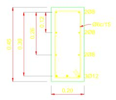
Se verifica si la armadura colocada tiene una resistencia mayor a M<sub>u</sub>.
