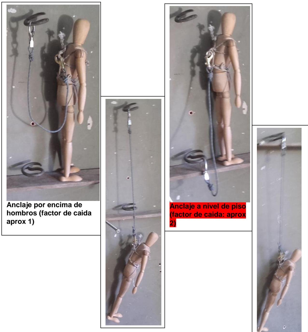
Fig 1.1 TA- Restricción de caída (en función del punto de anclaje)
