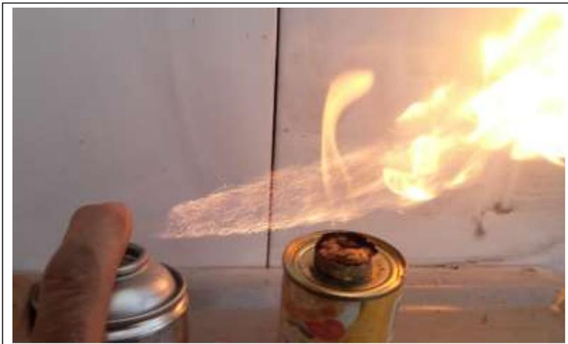
Fig Los gases no tienen Punto de inflamación (ya estan en estado gaseoso)
