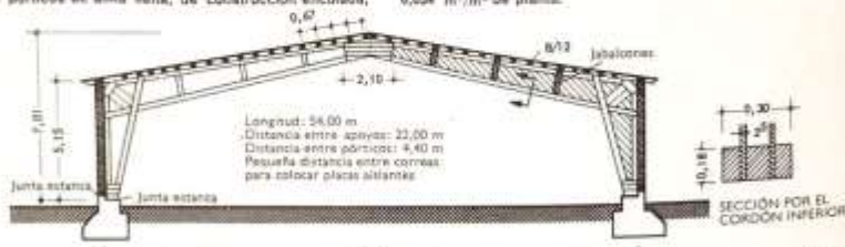
3 Nave para taller. Pórticos con sección hueca, con tres articulaciones. Las dos almas se forman con dos capas cruzadas de tablas en diagonal. Consumo de madera: 0,061 \text{ m}^3/\text{m}^2 de planta.
