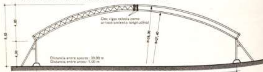
3 Nave para taller. Pórticos con sección hueca, con tres articulaciones. Las dos almas se forman con dos capas cruzadas de tablas en diagonal. Consumo de madera: 0,061 \text{ m}^3/\text{m}^2 de planta.
