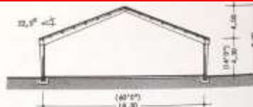
2 Pórticos con tres articulaciones, de hormigón pretensado. (Constr. Woolway Construcciones Lda, Belpert, Inglaterra.) Uniones: entre pies derechos y pares por los elementos de pretensado; en la clave, mediante pernos con planchas.
