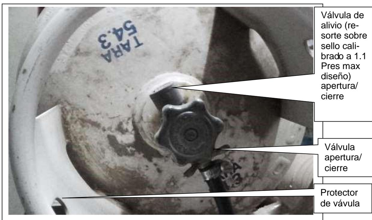
**Fig Ejercicio 4 Recip GL 45 kg: Propano (visto de arriba)**
